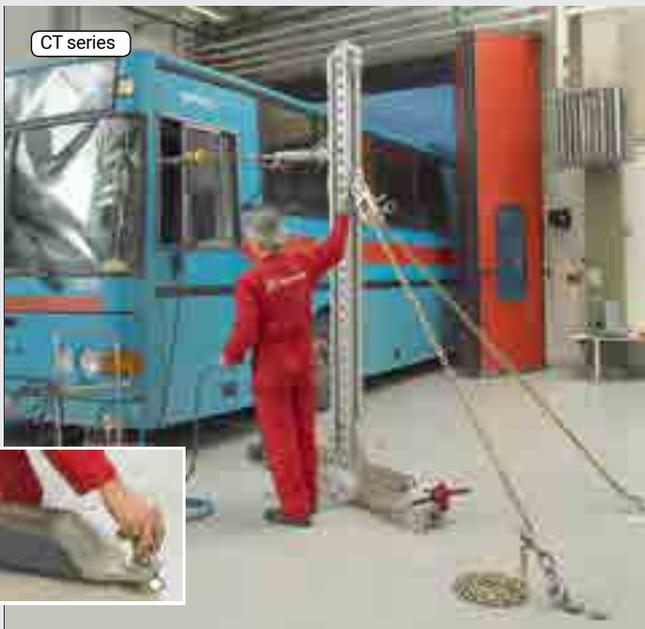
При ремонте небольших повреждений транспортных средств силовая башня крепится за анкерные цилиндры, запрессованные в отверстия в полу ремонтной зоны. В данном случае, силовая башня фиксируется спереди за носовой кронштейн, а сзади при помощи цепей. Угол между концами цепи регулируется и цепь фиксируется в блоке шплинтом (см. верхнюю стрелку) затем натягивается закручиванием винта (см. нижнюю стрелку).
